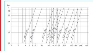
portata/perdita di carico e coefficiente nominale Kv II valore Kv è il valore indice in m³/h (con acqua a 15°C) che provoca la caduta di pressione di 1 bar
